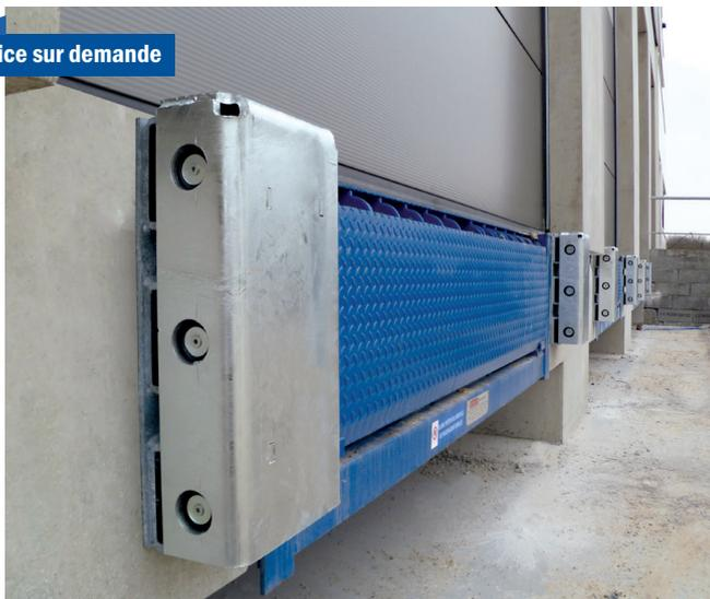
Recommandé pour les trafics intenses, le **BUTDOCK 130** permet d'amortir le véhicule contre le quai de façon optimale grâce à sa grande épaisseur (plus grande course). Il est équipé d'amortisseurs caoutchouc. Disponible avec platine rallongée, réhausse 100 mm, 150 mm ou 200 mm.
